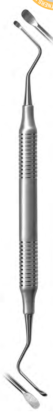
10 1298 84 1 Lucas # 84 NORDENT CSL84 Scharfe Löffel mit Spiegel-Arbeitsenden. Der Schaft ist 50° abgewinkelt und hat eine Reichweite von 20 mm. Die löffelförmigen Klingen haben einen länglichen Radius; die Löffel sind 2,4 mm breit. Bone curettes with mirror image working ends. The shank is 50° angled and has a range of 20 mm. The spoon-shaped blades have an elongated radius; the spoons are 2,4 mm wide.
