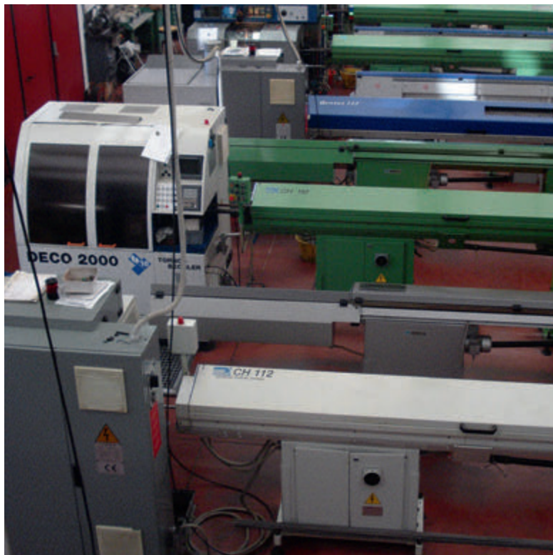
CNC Dept., for the manufacturing of Medesy's handle and tips. Reperto torni automatici CNC, per la produzione dei manici Medesy e relative punte.
